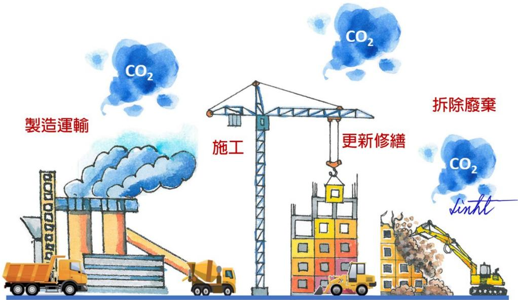
圖 12 蘊含碳排 EC 之製造運輸、施工、更新修繕、拆除廢棄等四階段評估
