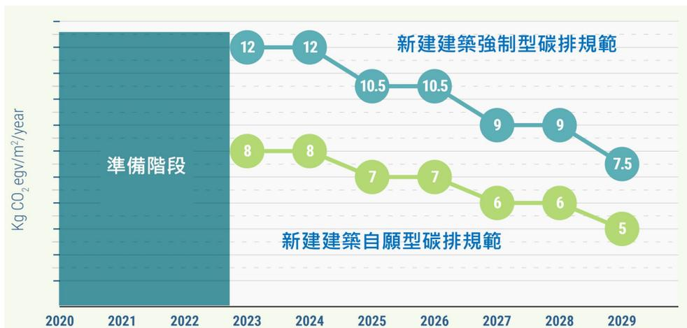
圖 7 丹麥內政&住宅部 2021 年新設立管制建築總碳排的永續建築法規
